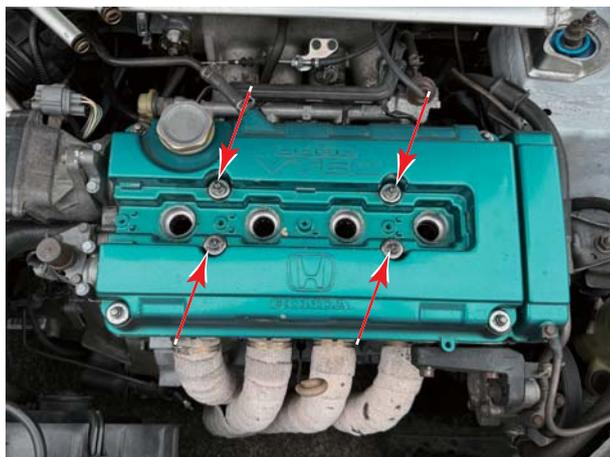
4. 手順3で取り外したナットを使用して、②コイルブラケットを取り付けてください。
